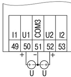
Fig. 5.6 Voltage signal (0-10 V)
