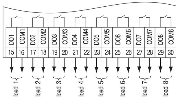
Fig. 5.8 Output wiring
